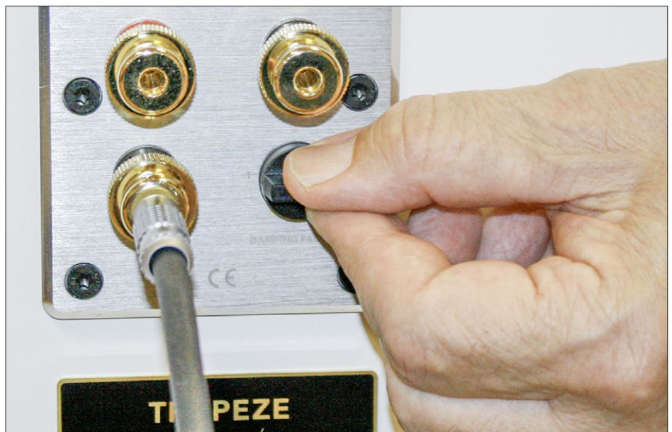
Alles an seinem Platz, aber schlecht lesbar: Anschluss fürs LS-Kabel ist oben, in der unteren Reihe links der „Freedom“-Anschluss fürs Erdungskabel, daneben der 3-stufige Schalter für die Dämpfung.
