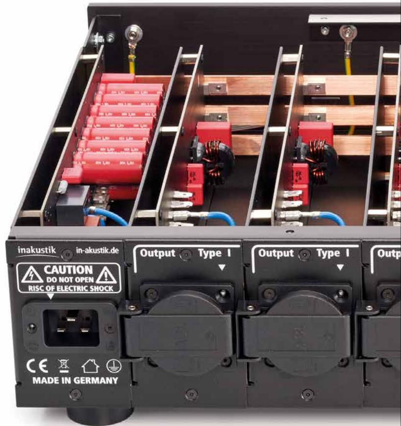
Sechs hochkarätige Komponenten verlangen nach einer großzügigen Stromzufuhr. Die maximale Leistungsaufnahme liegt demnach bei 3680 VA, was bei 230 Volt 16 Ampère entspricht und demnach eine C20-Steckdose nötig macht. Wie bei in-akustik üblich, ist diese phasenmarkiert.
