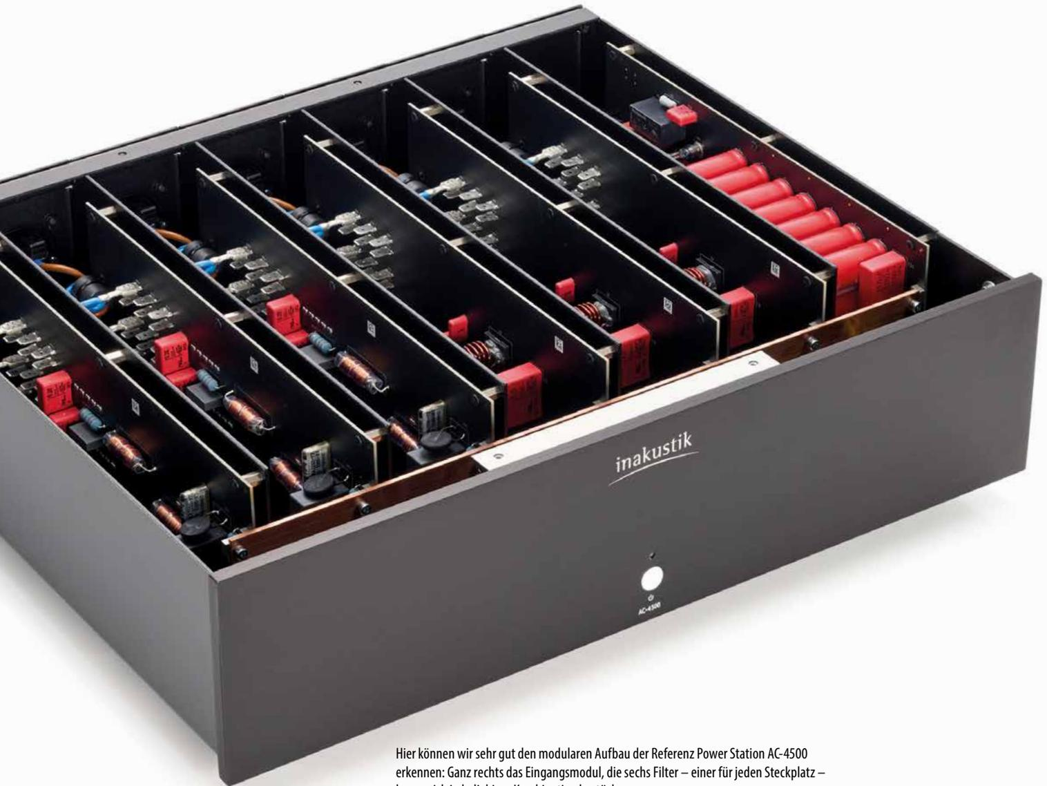
Hier können wir sehr gut den modularen Aufbau der Referenz Power Station AC-4500 erkennen: Ganz rechts das Eingangsmodul, die sechs Filter – einer für jeden Steckplatz – lassen sich in beliebiger Kombination bestücken.
