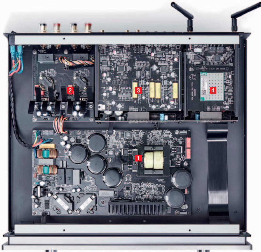
Schaltnetzteil (1) und Verstärkerstufe (2) bilden eine kompakte, aber unglaublich leistungsfähige Einheit; die effiziente Class-D-Topologie benötigt wenig Kühlfläche. D/A-Wandler (3) und Streaming-Modul (4) sind optional.
