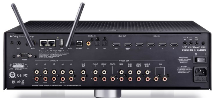
3D-Soundformate, sechs HDMI-Anschlüsse, drei Digitaleingänge, USB, Bluetooth, Dirac-Live-Raumeinmessung – wenn das nicht komplett ist...
