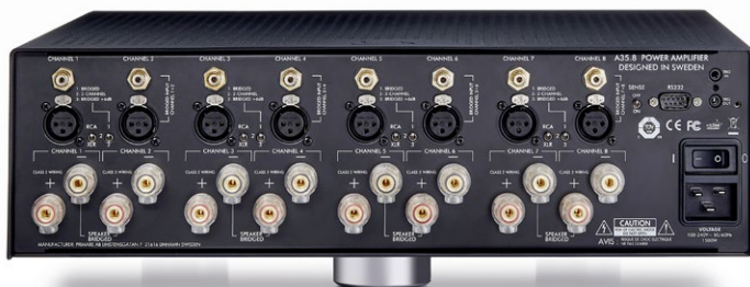
Primares A35.8 ist eine beeindruckende Leistungsendstufe, die vier Kanäle als Brückenverstärker oder bis zu acht „einzeln“ befeuert.
