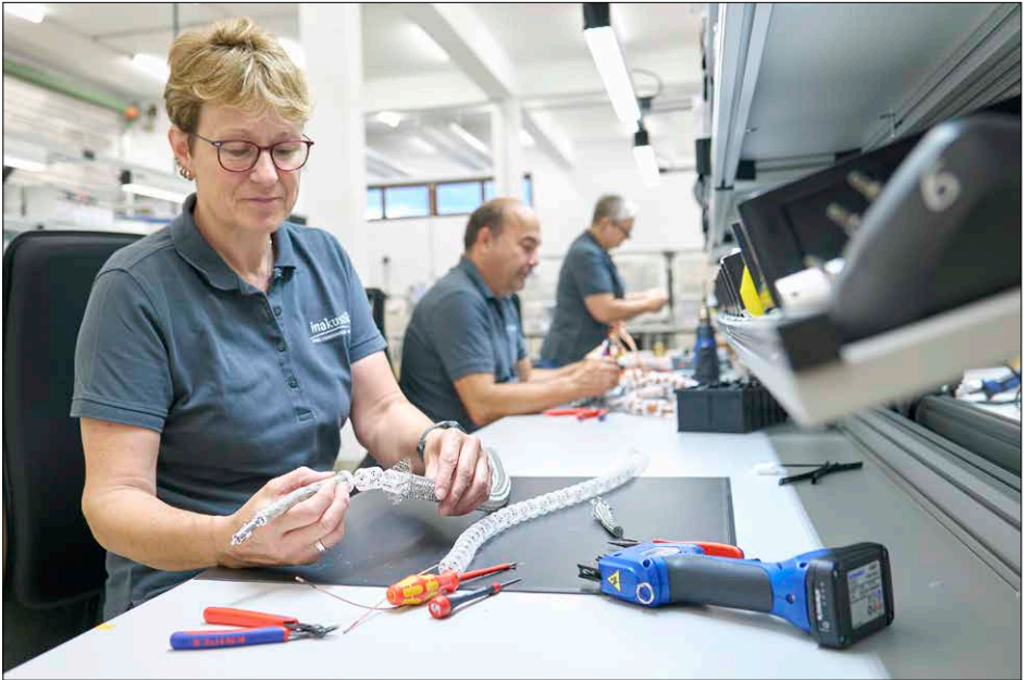
An mehreren Arbeitsplätzen im Werk in Ballrechten-Dottingen werden die AIR-Kabel von Hand gefertigt und in puncto Länge wie auch Art der Anschlüsse nach Kundenwunsch konfektioniert.
